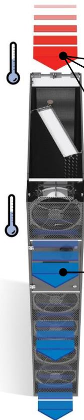
**Вентиляторы ЕС: регулировка в зависимости от температуры входящего воздуха**
